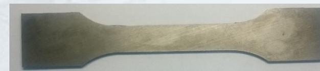
Образец для механических испытаний
