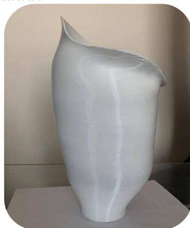
ИМП, изготовленный по аддитивному технологическому процессу
